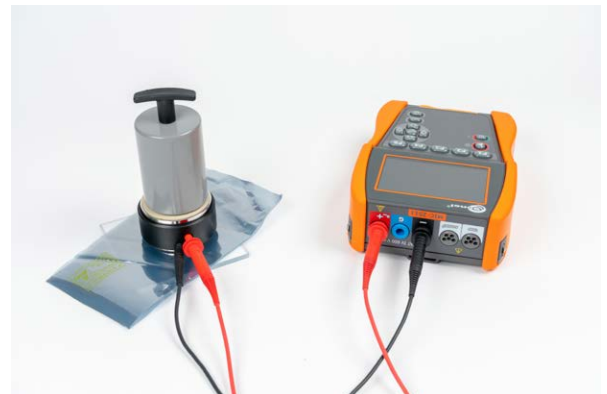
Juego para medir resistencia en áreas protegidas de ESD con espacio para el medidor
