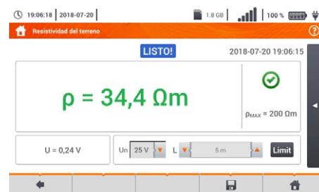
Medición de la resistividad del suelo
