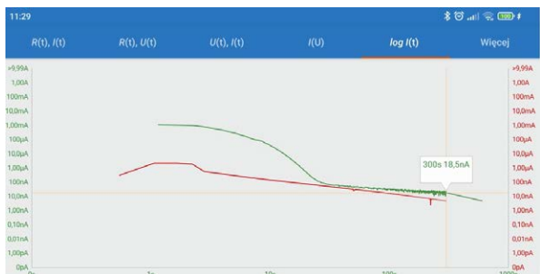
Mediciones de PDC (Sonel MIC Mobile)
