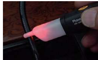
Encendido LED rojo con tensión detectada
