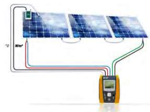
Medida de una curva I-V con sincronización a distancia de irradiación y temperatura
