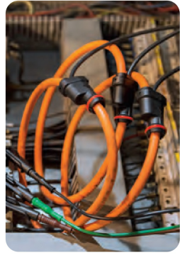
4 maxilares flexibles para la medida de corriente incluyendo la intensidad de neutro
