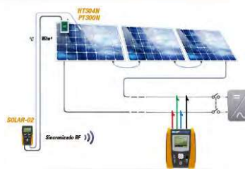
Medida de una curva I-V con sincronización a distancia de irradiación y temperatura
