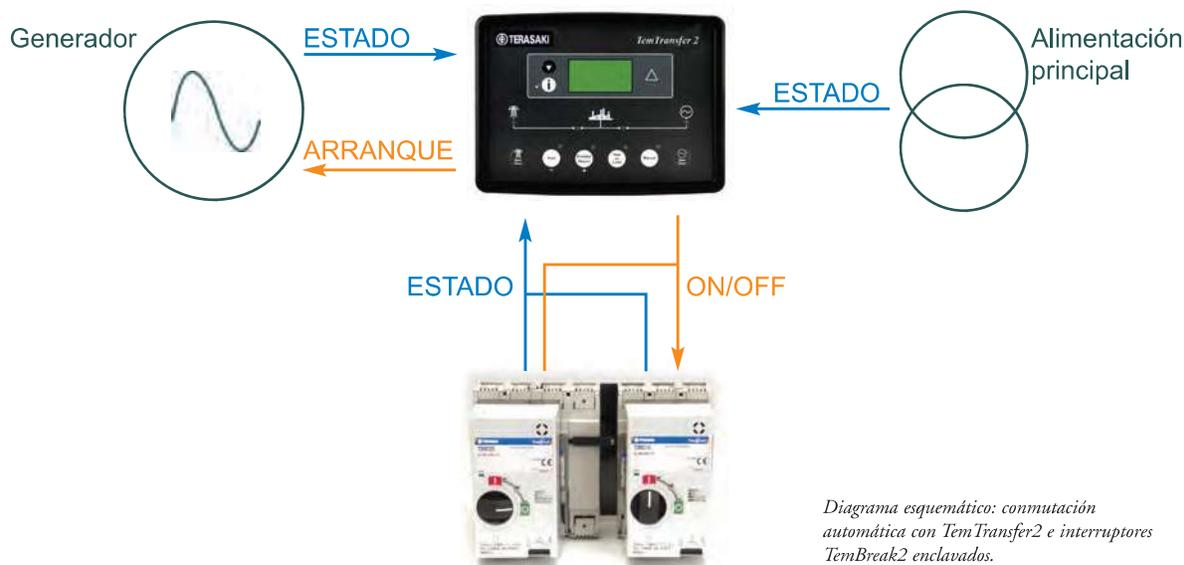
Diagrama esquemático: conmutación automática con TemTransfer2 e interruptores TemBreak2 enclavados.
