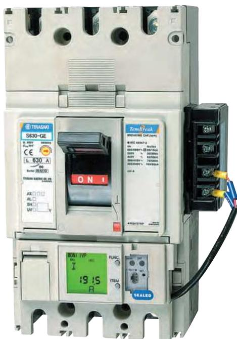
El interruptor electrónico avanzado TemBreak2 con VT y CT integrados, monitoriza la corriente, el voltaje, la potencia eléctrica instantánea, la energía eléctrica integrada y el factor de potencia de un circuito. Este interruptor permite -mediante el protocolo Modbus- permite que datos como los valores medidos y el registro de fallos puedan ser transmitidos a un mecanismo externo.
