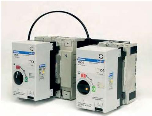
*Dos interruptores conmutados con enclavamiento mecánico mediante cable, enclavamiento eléctrico de motores y dos mandos motor*
