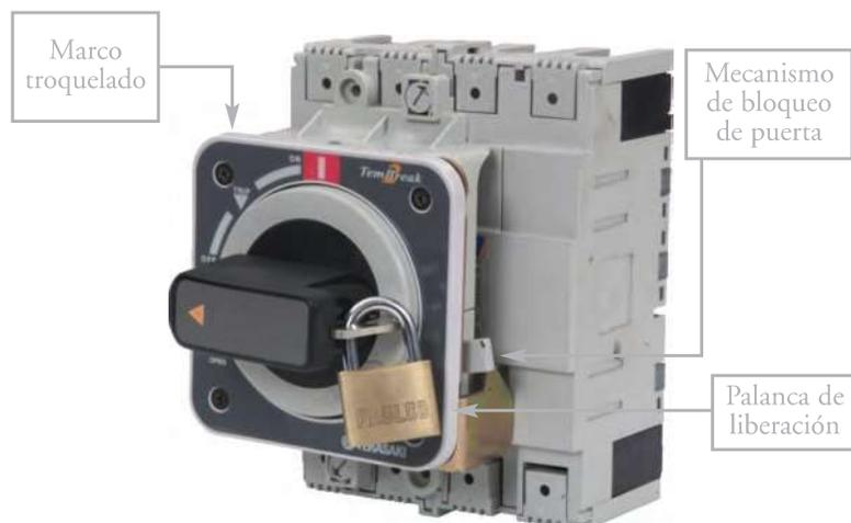
Este mando se utiliza para accionar un interruptor montado justo detrás de la puerta cerrada de un compartimento. El mecanismo de operación y el mando van directamente montados sobre el interruptor. El mando sobresale a través del troquel en la puerta. Junto con el mando se suministra un marco embellecedor para cubrir el troquel realizado en la parte frontal.
